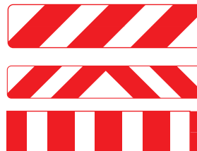
O 43, 44, 45: Spærrebomme. Anvendes bl.a. hvor vej eller sti ophører, eller hvor vejbredden brat formindskes. Ved bomme med skrå striber fortsætter vejen til den side, som striberne hælder ned imod.
